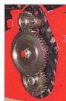
Robusta trasmissione laterale ad ingranaggi per resistere in terreni difficili.
