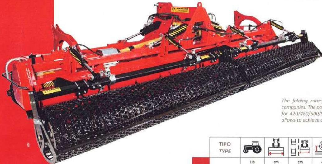
La fresatrice pieghevole **TITAN** è una macchina rivolta a soddisfare le esigenze di contoterzisti e aziende agricole di grandi dimensioni. La particolare progettazione del telaio permette di contenere il suo ingombro in condizioni di trasporto a soli 2,5 metri per i modelli 420/460/500/540 e a soli 3 metri per i modelli 600 & 720; la sua struttura robusta permette inoltre di ottenere un ottimo risultato anche in condizioni estreme.
